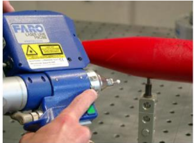
使用 FARO 扫描臂对机身模型进行扫描
